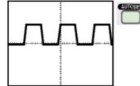
3. Pulse el botón **AUTOCONFIGURAR**. En unos segundos, debería ver en la pantalla una onda cuadrada de aproximadamente 5 V pico a pico a 1 kHz.
