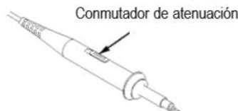
**NOTA.** Cuando el conmutador de atenuación se establece en 1X, la sonda P2220 limita el ancho de banda del osciloscopio a 6 MHz. Para utilizar ancho de banda completo del osciloscopio, asegúrese de establecer el conmutador en 10X.
