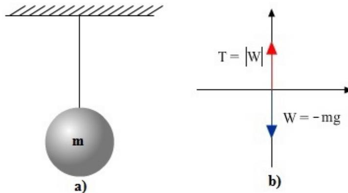
Figura 4.8: Diagrama de cuerpo libre de un cuerpo que pende de una cuerda.
