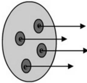
Figura 5.10: Vista transversal de un conductor, donde fluyen electrones.
