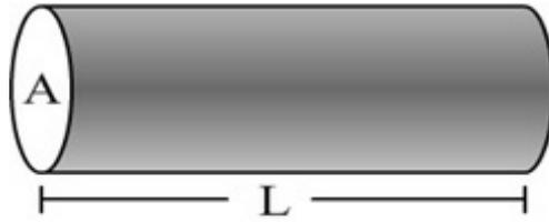
Figura 5.9: Parámetros geométricos de un conductor cilíndrico.
