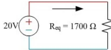
Figura 5.16: Resistor equivalente de la conexión en serie.
