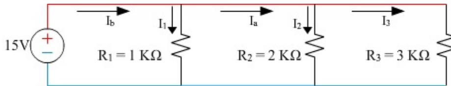
Figura 5.18: Conexión en paralelo.
