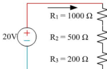
Figura 5.15: Resistores conectados en serie.
