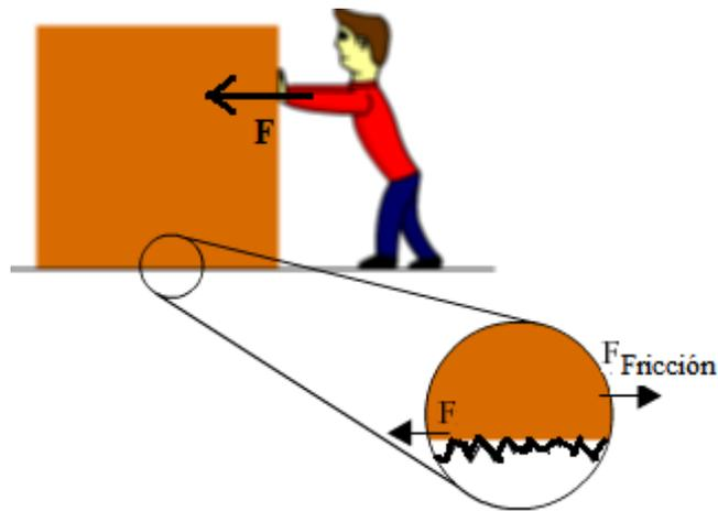
Figura 4.12: Fuerza de fricción debida a la rugosidad de la superficie.
