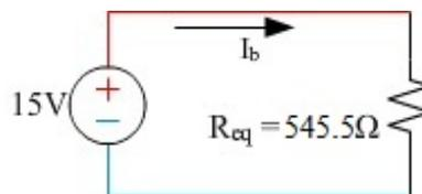
Figura 5.19: Resistencia equivalente de una conexión en paralelo.
