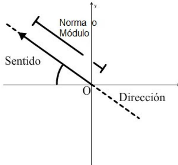
Figura 2.4: Componentes de un vector.
