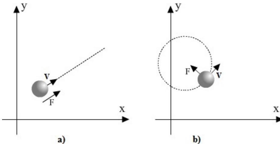
Figura 4.4: Una fuerza acelera la partícula. a) Trayectoria rectilínea b) Cambia la trayectoria rectilínea.
