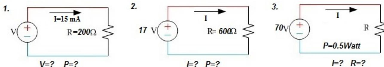
Figura 5.14: Circuitos para la sección de ejercicios Taller.
