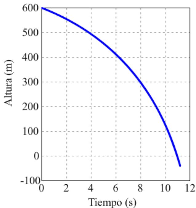
Figura 3.27 : Altura con respecto al tiempo de un cuerpo en caída libre.
