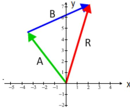
Figura 2.16 : Suma de vectores por el método del triángulo.
