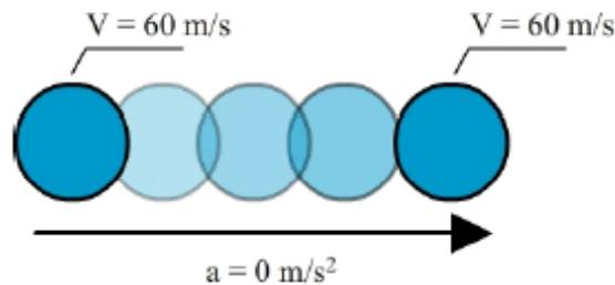
Figura 4.2: Cuerpo en movimiento rectilíneo uniforme.
