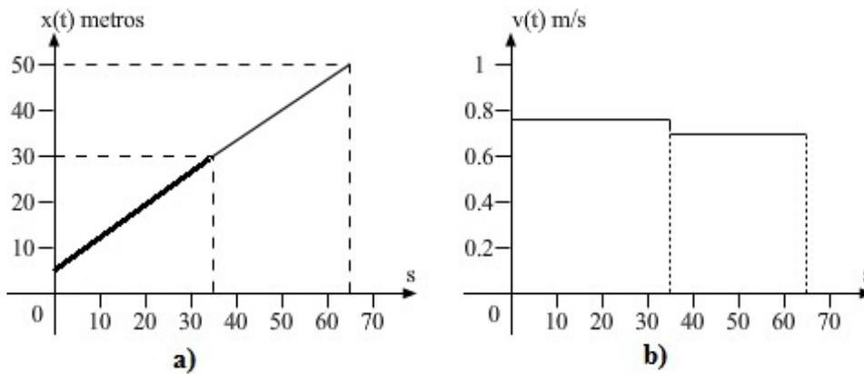
Figura 3.5: Gráficas de la posición y la velocidad dependientes del tiempo.
