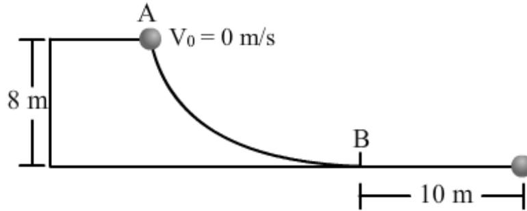
Figura 4.21: Conservación de la energía de un cuerpo que se desliza por una rampa.
