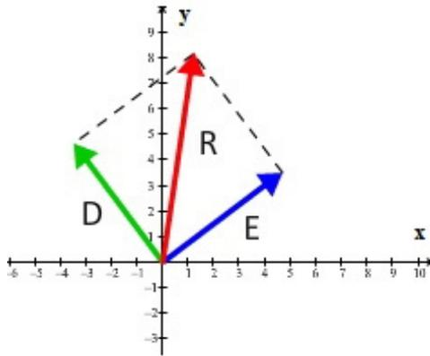
Figura 2.17: Suma de vectores por el método del paralelogramo.
