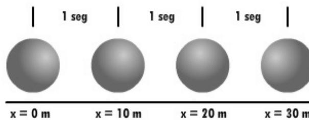
Figura 3.2: Cinemática de una partícula en movimiento a velocidad constante.
