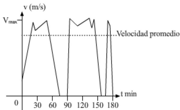
Figura 3.15 : Velocidad instantánea con respecto al tiempo de un automovilista.
