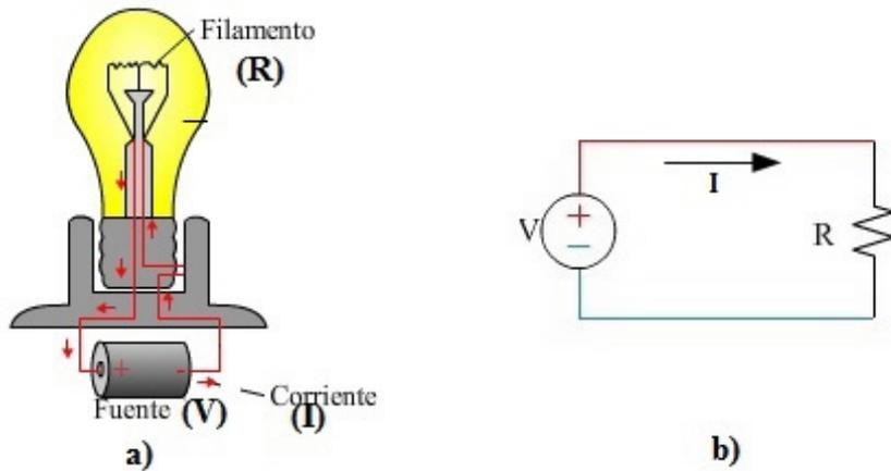
Figura 5.12: (a) Un foco conectado a una batería. (b) Un circuito que esquematiza las conexiones.
