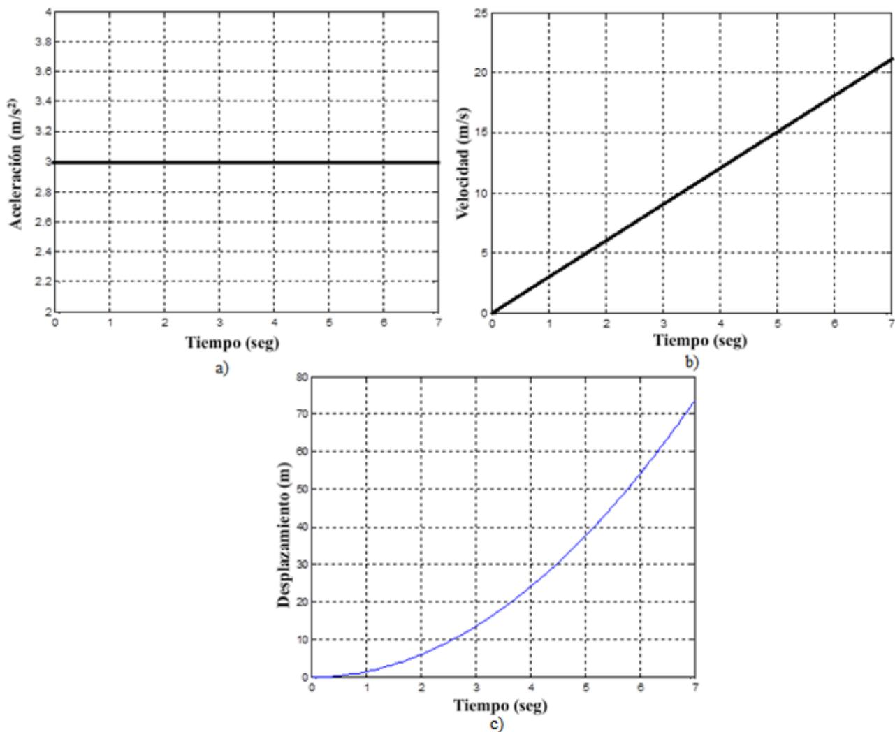
Figura 3.21: Aceleración, velocidad y posición de una partícula con respecto al tiempo.
