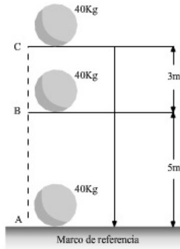
Figura 4.18: Trabajo requerido para levantar un cuerpo.
