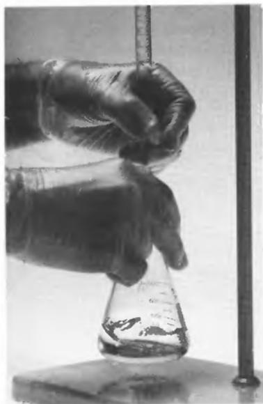
Figura 9.1 Forma adecuada de manipular la llave de una bureta y el matraz durante una titulación.
