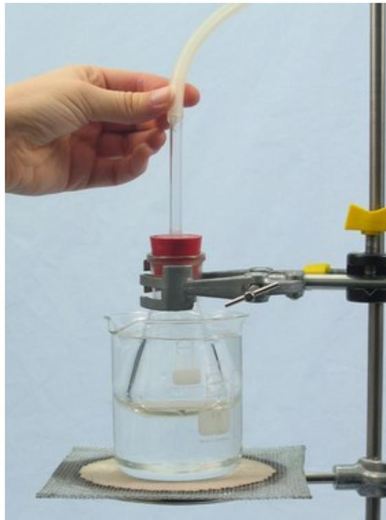
Fig. 6 Colocación de la manguera flexible al tubo del Matraz Erlenmeyer
