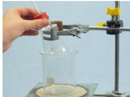
Fig. 2 Colocación del Matraz Erlenmeyer con La pinza universal
