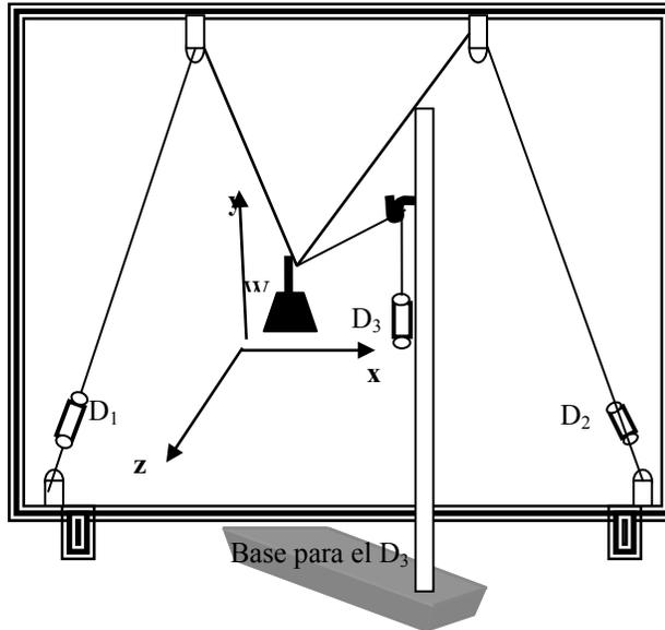
Fig. 2. En esta figura se muestra el esquema del arreglo que se debe hacer en esta práctica. Los rectángulos representan a los dinamómetros.
