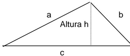
Perímetro  $P = a + b + c$     Área:  $A = \frac{1}{2}ch$  (base por altura perpendicular a la base por  $\frac{1}{2}$ )
