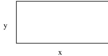
Perímetro  $P = 2x + 2y$     Área:  $A = xy$     (recuerde: base por altura)
